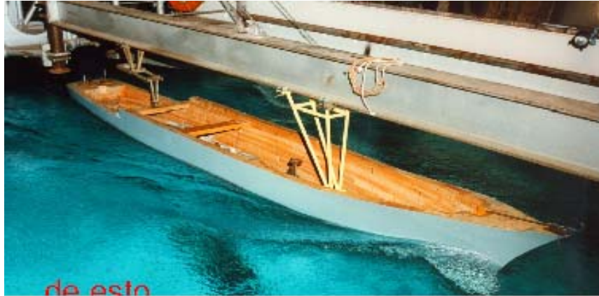
Figura 14. Ensayo de resistencia de carena
