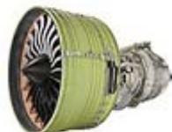
Los turbo-reactores han experimentado una enorme evolución desde sus inicios. Se han desechado los compresores centrífugos generalizándose el uso de los compresores axiales e incrementándose el número de escalones de compresor y de turbina.
