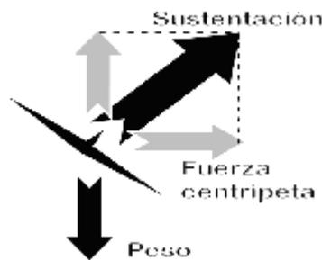
Cuando se hace un viraje de  $60^\circ$ , para mantener la altura se debe doblar la sustentación, ya que las fuerzas centrípetas con esa inclinación producen una aceleración igual al peso con lo que se alcanzan los 2G, es decir, 2 veces la fuerza de la gravedad, la sensación es como si pesáramos exactamente el doble. Los aviones comerciales limitan el ángulo de alabeo a  $30^\circ$  porque así se restringe el factor de carga a 1,15G, valor confortable para el pasaje.
